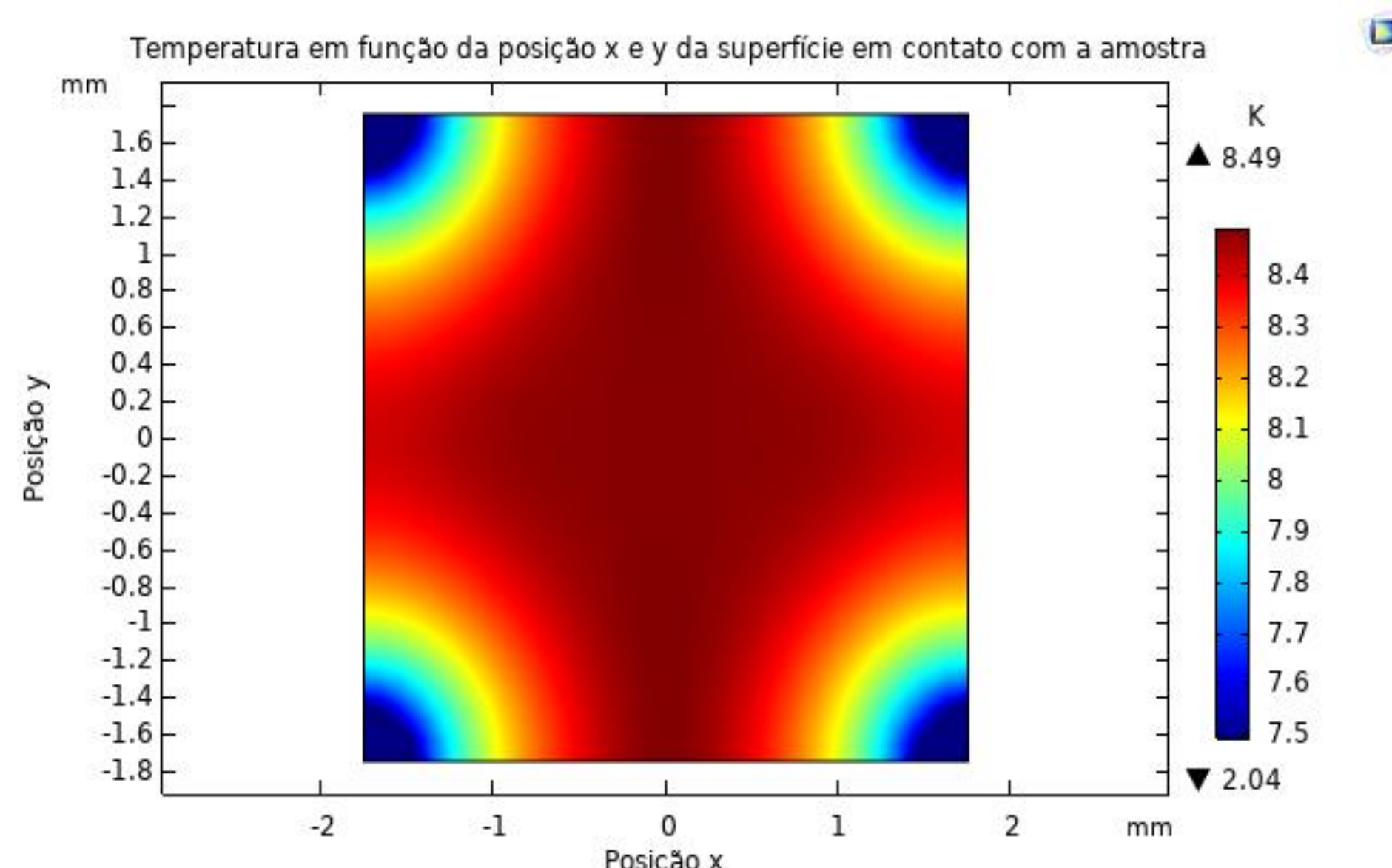
Figura 3- Gradiente de temperatura da superfície do suporte em contato com a amostra. As cores quentes indicam temperaturas mais elevadas (próximas ao vermelho) e a medida que as cores se tornam frias (se aproximam do azul) indica uma diminuição da temperatura. (fonte: autor)
