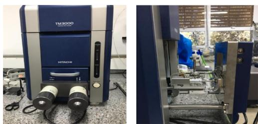
**Figura 2:** Microscópio Eletrônico de Varredura (MEV) e porta base com amostras.
