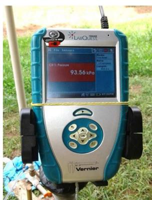
Figura 3. Módulo do sensor de pressão: interface com o usuário para programação da frequência amostral.
